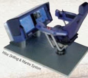
6. CETTE CONSOLE DE FORAGE permet à un ingénieur de surveiller des capteurs proches du trépan afin de savoir si celui-ci est dans la bonne direction pour forer la couche qui contient du pétrole. Le trépan peut alors être orienté.
